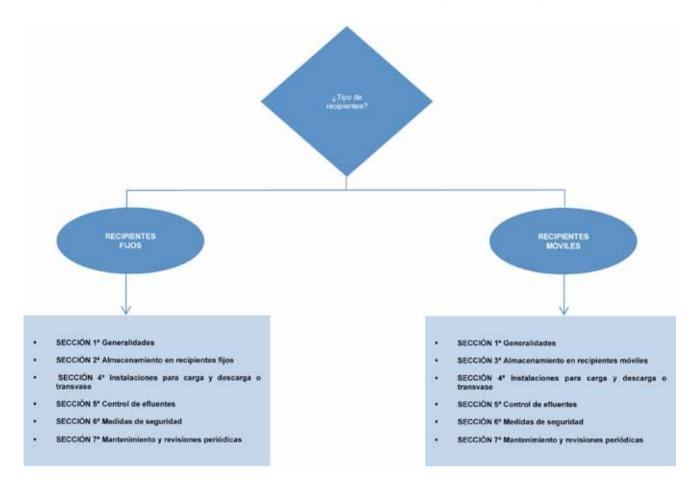
Figura III.7 Estructura de la ITC MIE APQ 7 aplicables a las instalaciones de almacenamiento de líquidos tóxicos
