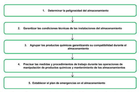
Figura 1. Puntos críticos para garantizar la seguridad en el almacenamiento de productos químicos
