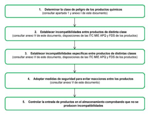
Figura 5. Procedimiento para evitar incompatibilidades en el almacenamiento de productos químicos
