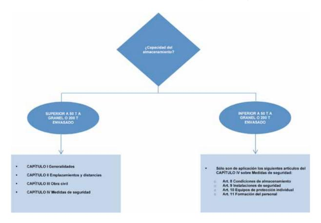
Figura III.8 Estructura de la ITC MIE APQ 8 aplicable a las instalaciones de almacenamiento de fertilizantes a base de nitrato amónico con alto contenido en nitrógeno
