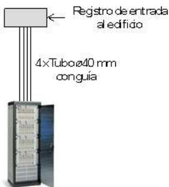
Figura 16. Esquema del Subsistema de Interconexión (acometida superior)
